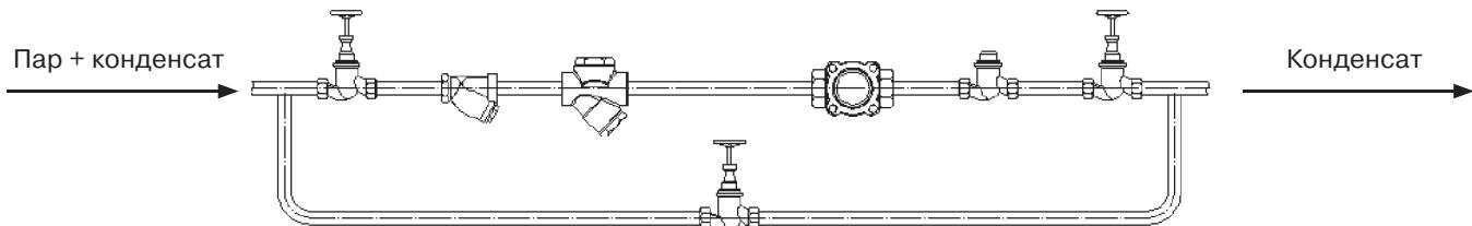
**Рекомендуемый коэффициент запаса:** при непрерывной работе – 1,2-1,5; при периодической работе – 2.
